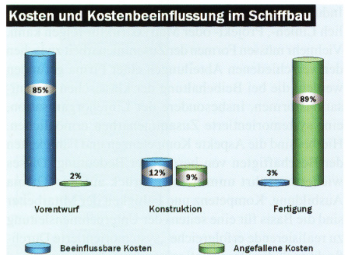
Abb. 1. Kosten und Kostenbeeinflussung im Schiffbau
